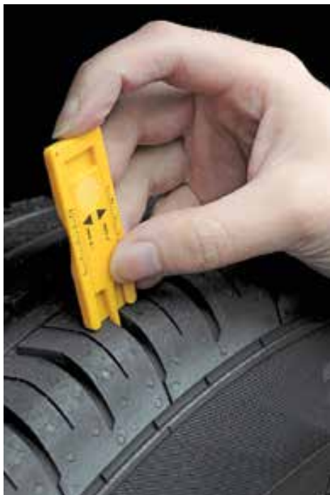
strumento universale per controllare l'usura degli pneumatici
